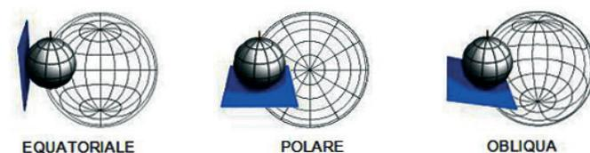
Figura 1.2.11 Esempi di proiezioni prospettiche: equatoriale, polare, obliqua
